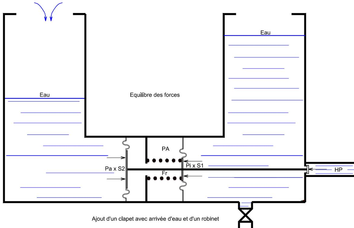
Entrée automatique d'eau HP par un clapet actionné par les pointeaux solidaires des membranes.
